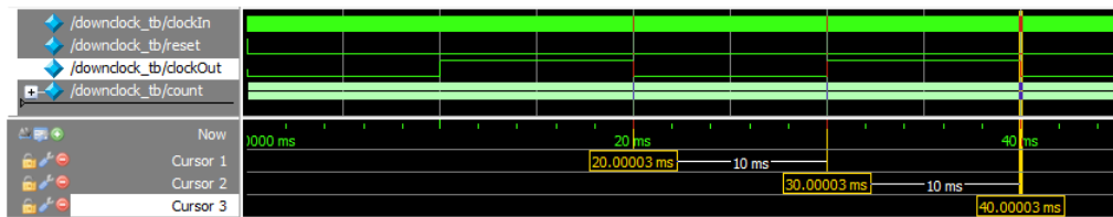
Figura 4.9: Simulazione RTL del divisore di frequenza di clock.
