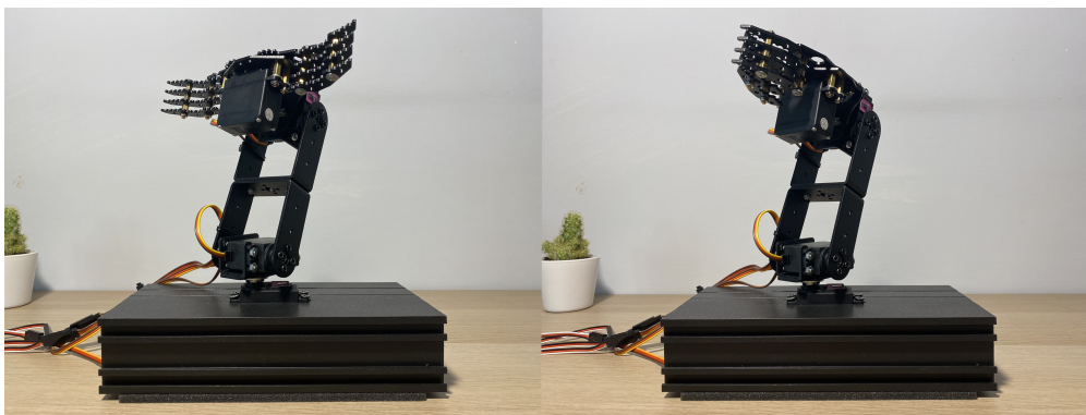
Figura 5.7: Apertura e chiusura del gripper.
